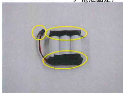
(電池端子連結部 ／コネクタ部の被覆)
