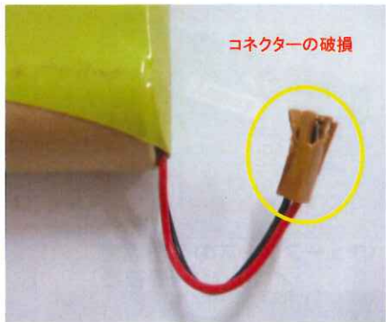
(コネクタ部の破損) コネクタ内でリード線同士が接触し 短絡の可能性あり
