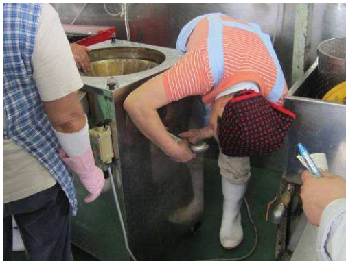
ジュースの抽出口を取り付ける
