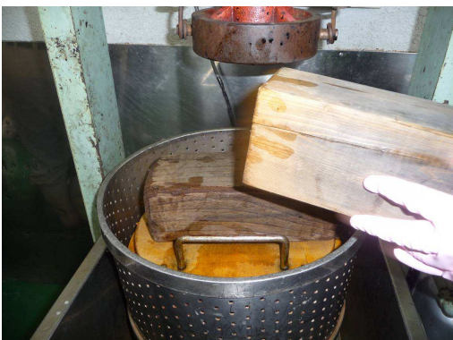
押ぶたの上に枕木を設置する
