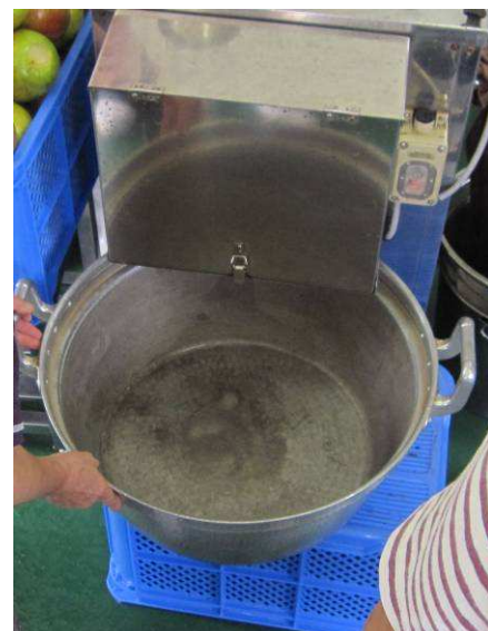
搾りカス排出箱の下に鍋を取り付ける
