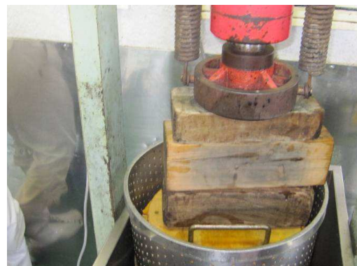
ジャッキとの間があきすぎないように枕木を置き、壁の電源をONにする
