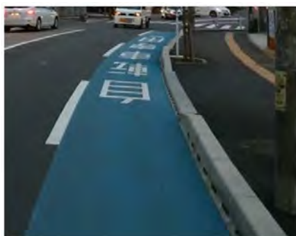
【街渠をエプロン幅の狭い平坦性の高いものに置き換えた事例】
