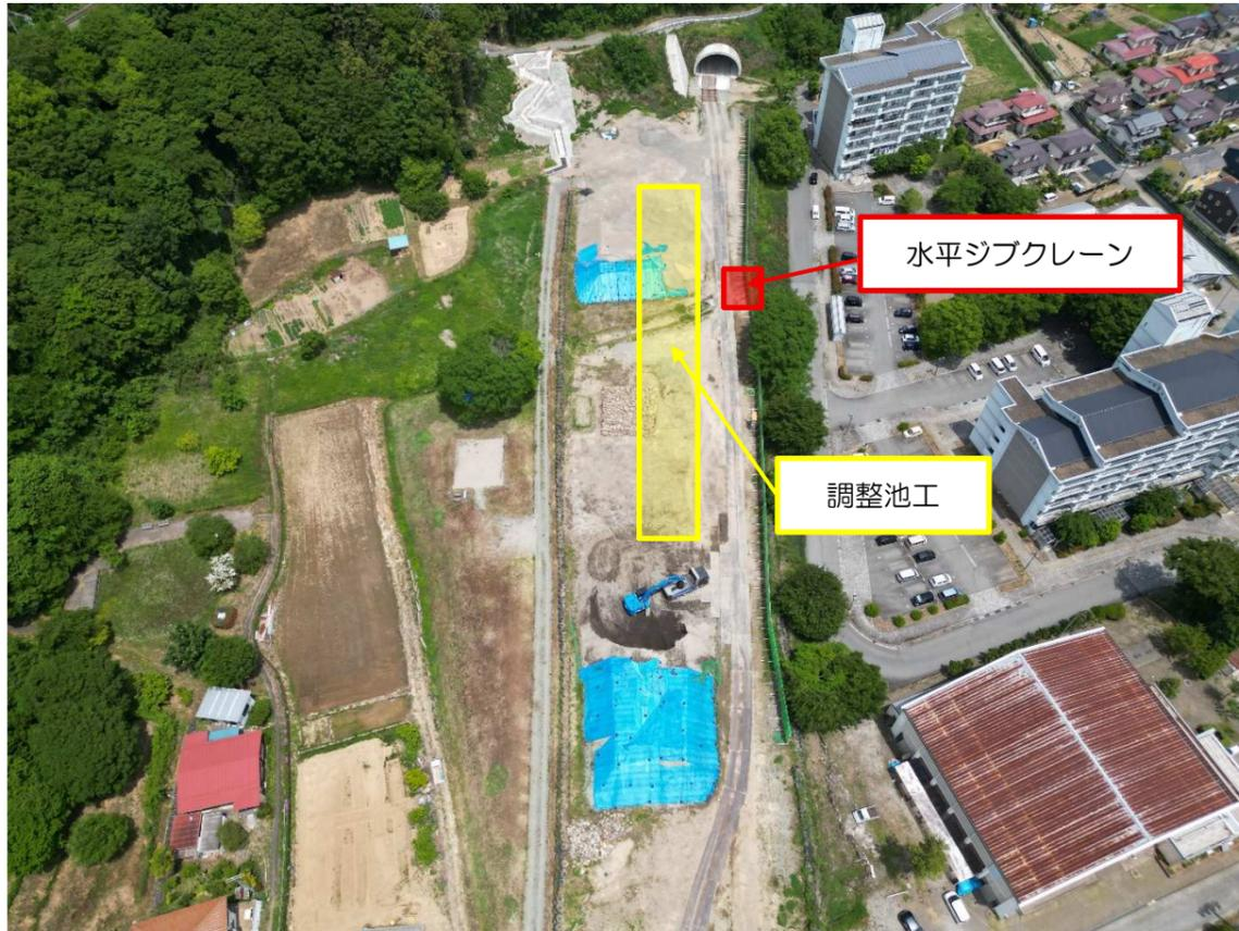
水平ジブクレーン設置位置図
