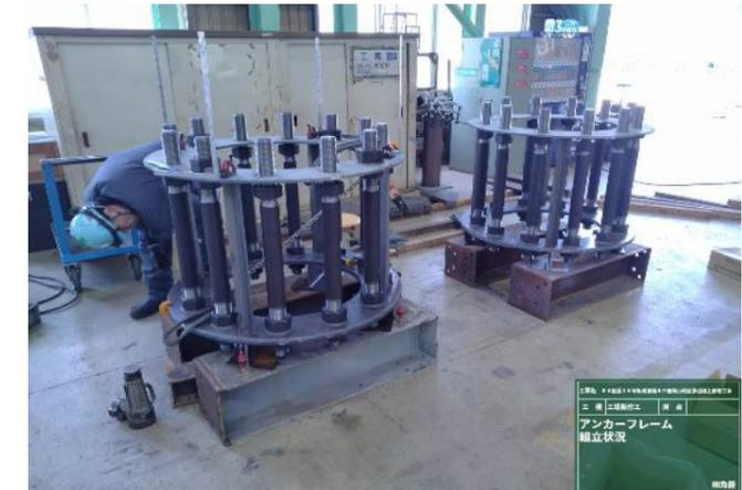
工場製作工 橋脚（支柱）固定ボルト組立状況
