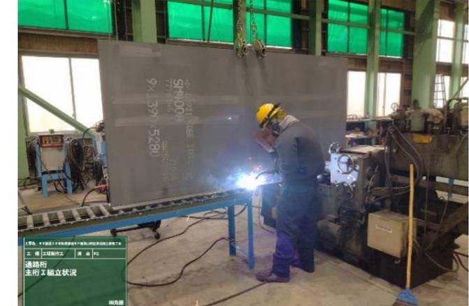
工場製作工 通路桁組立状況
