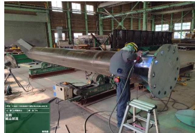
工場製作工 橋脚（支柱）の組立状況
