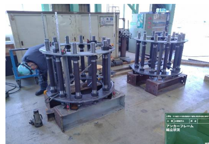
工場製作工 橋脚（支柱）固定ボルト組立状況
