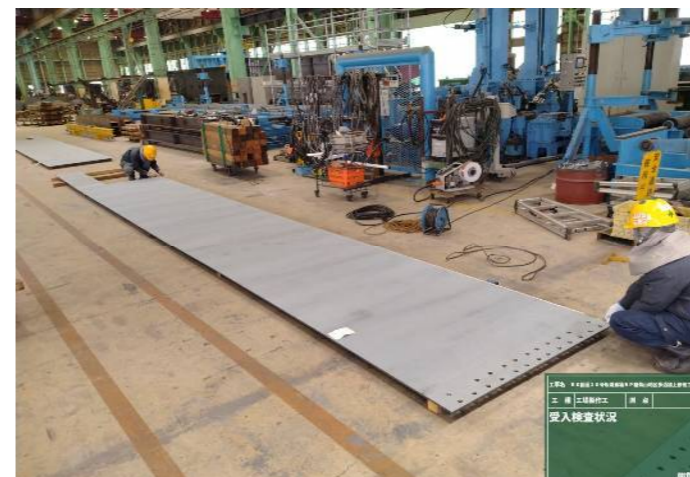
工場製作工 鋼板の受入検査
