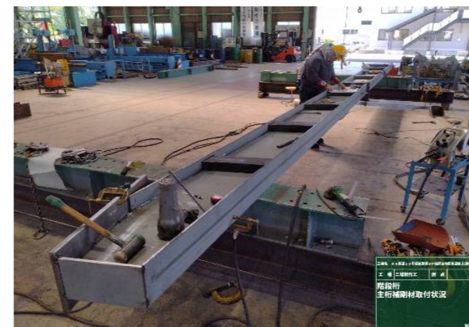
工場製作工 階段けた組立状況
