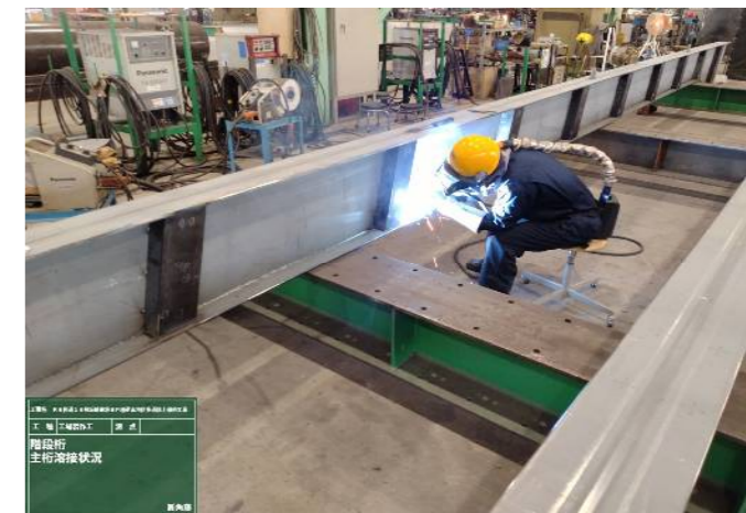
工場製作工 階段けた溶接状況
