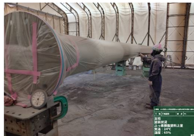
工場塗装工 塗装状況（橋脚）
