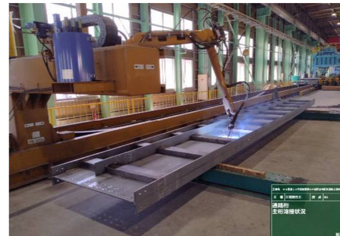
工場製作工 通路けた溶接状況（溶接ロボット）
