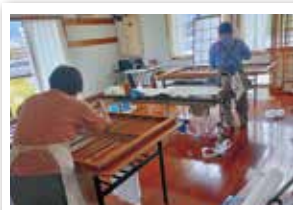
お盆前に依頼の多い障子張り
