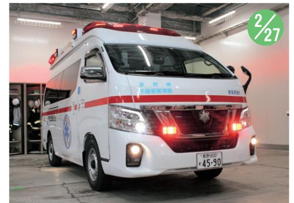
千曲坂城消防本部は、更埴消防署に配備される新型の災害対応特殊救急自動車の運用開始式を、同本部内で開きました。新車両には、車体上部に作業灯が設置されているため、夜間や震災などで電力が遮断されても、安全に救急活動を行なうことができます。車内には、最新のエア防振架台をはじめとした救命措置に必要な資機材を搭載しています。また新車両は、大規模災害発生時に被災地で活動する「緊急消防援助隊」の出動車両としても登録されています。
