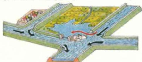
大きな洪水の時は洪水の一部を越流堤から計画的に遊水地に導き、一時的に貯留し下流河川の流量を低減させます。
