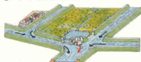
河川を流れる洪水が遊水地の越流堤を超えない程度の中小洪水の時は遊水地内の水をポンプで吐き出し、浸水させません。
